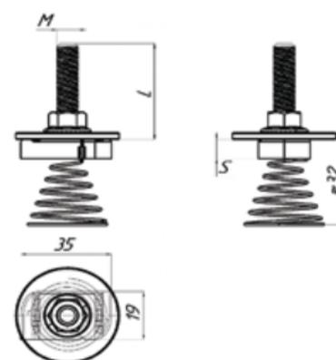
T-болт с пружиной M10, M12 не подходит для профилей с высотой 21 мм
