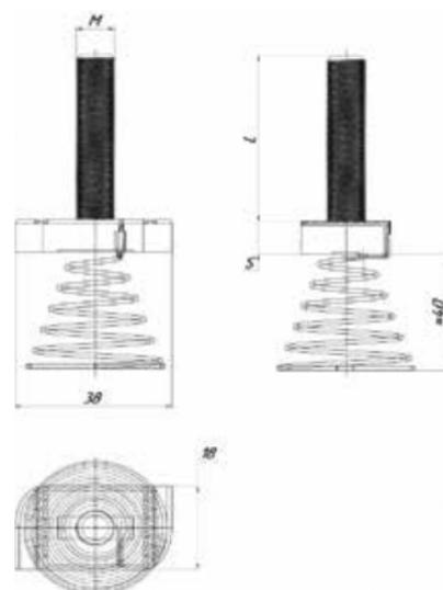
Т-болт с пружиной M10, M12 не подходит для профилей с высотой 21 мм
